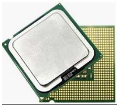
CPU Pentium 4 sản xuất năm 2006 với tốc độ 3,2GHz tốc độ này nhanh gấp 32.000 lần tốc độ CPU ban đầu
