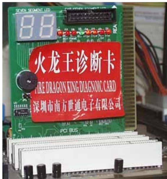
Gắn Card Test Main vào khe PCI
