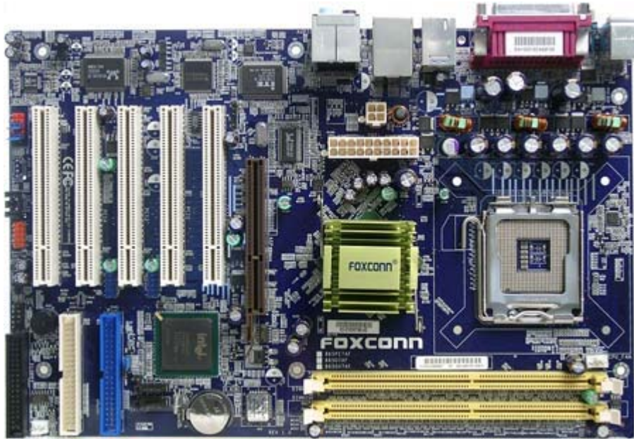
Mainboard máy Pentium 4 (Đời mới) - Socket 775
