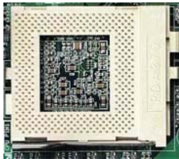
Đế cắm CPU - Socket 370 trong các máy Pentium 3
