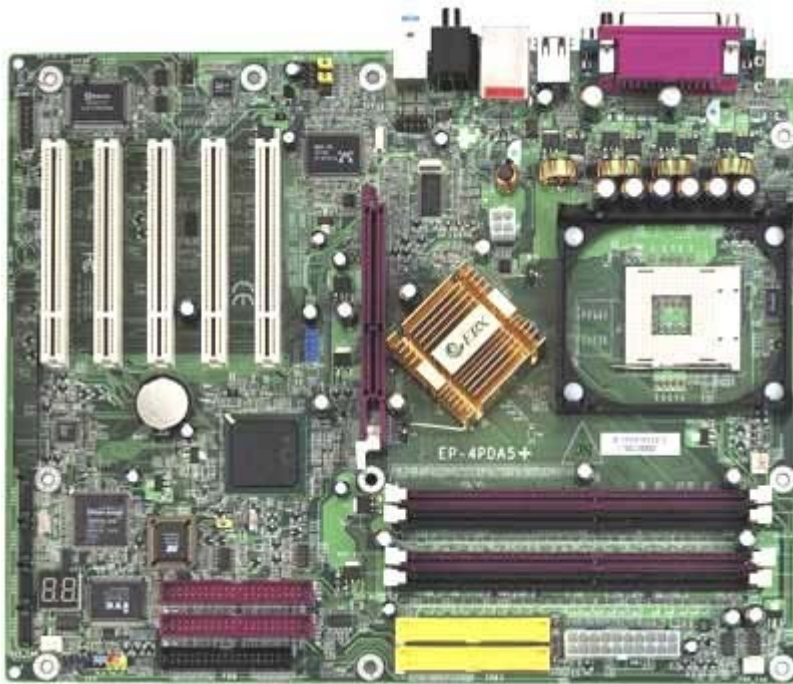
Mainboard máy Pentium 4 ( Đời trung ) - Socket 478
