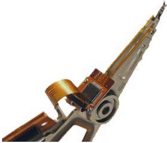
Cần mang đầu từ và IC khuếch đại tín hiệu đầu từ
