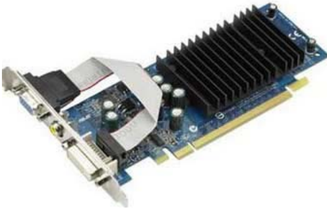
Card Video PCI Express 16X Tốc độ 16 \times 66\text{MHz} = 1056\text{MHz} Sử dụng trong các máy Pentium 4 đời mới nhất .
