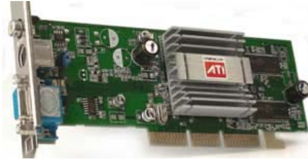
Card Video AGP 8X Tốc độ 8 \times 64\text{MHz} = 512\text{MHz} Sử dụng cho thế hệ máy Pentium 4
